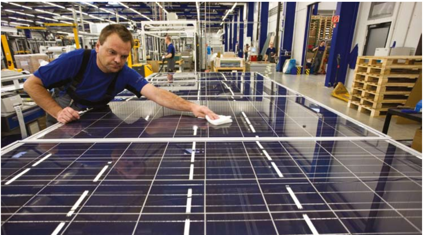
Letzte Polierarbeiten an Dünnschichtmodulen; Quelle: BMU-Bilderdatenbank
